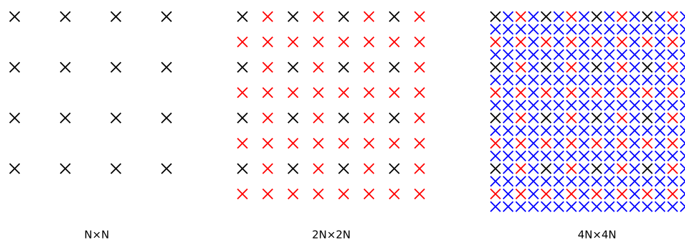
Obrázek 3.8: Interpolace bloku 4x4 pro přesnost kompenzace pohybu 1/2 pixelu a 1/4 pixelu
