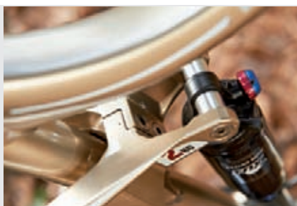
>> Sehr antriebsneutral ist der Hinterbau des Bark mit 155 mm Federweg.
