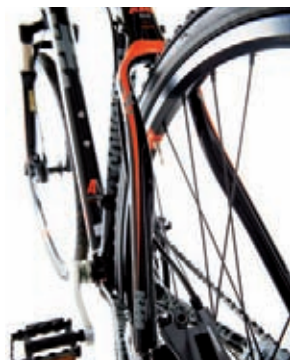
Stabil und leicht: der Carbon-Rahmen des KTM
