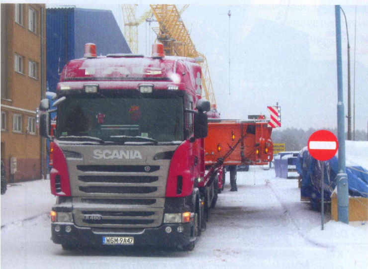
Transportiert wurden um 6,2 m breite Offshore-Anlagenteile.
