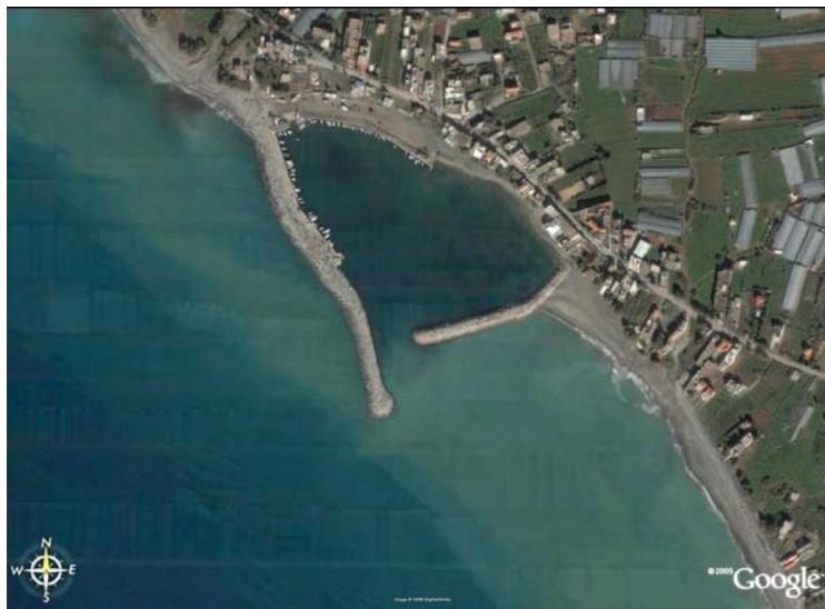
Σχήμα 6.4.2.2-8 Λιμενίσκος Κόρκκινου Πύργου - Συσσώρευση ιζήματος στην ρίζα του υπήνεμου μώλου
