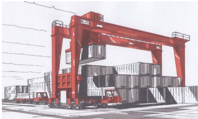
Γερανογέφυρα επί ελαστικών τροχών
