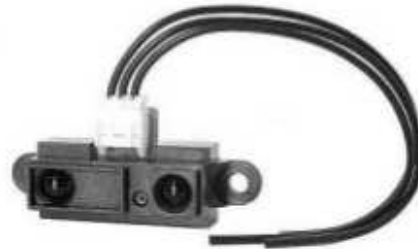
Bild 2.20: Sharp Entfernungssensor GP2D12
