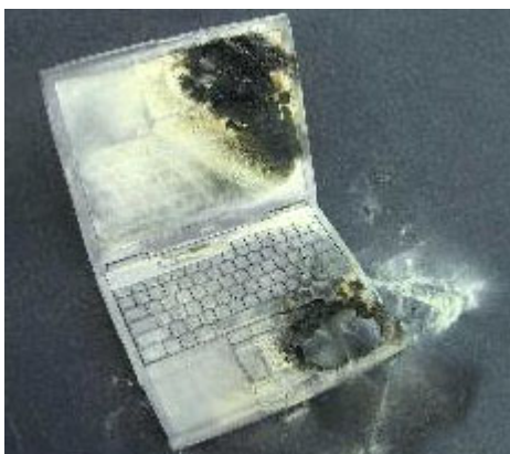
Figura 1: Ordenador portátil dañado por la batería de ion-litio.
