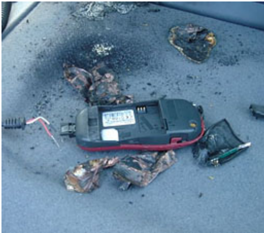
Figura 2: Un teléfono celular con una batería sin marca expulsando gases en llamas durante la carga en la parte trasera de un coche.
