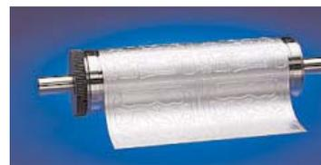
Una lámina flexible que se monta sobre un cilindro y realiza la misma operación que el anterior.
