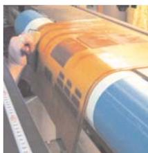
**Sleeves:** con soporte rígido (níquel o fibra de vidrio) se usan a modo de funda o camisa. Estas planchas son completamente cilíndricas y huecas para insertarlas a los cilindros preparados para ello.
