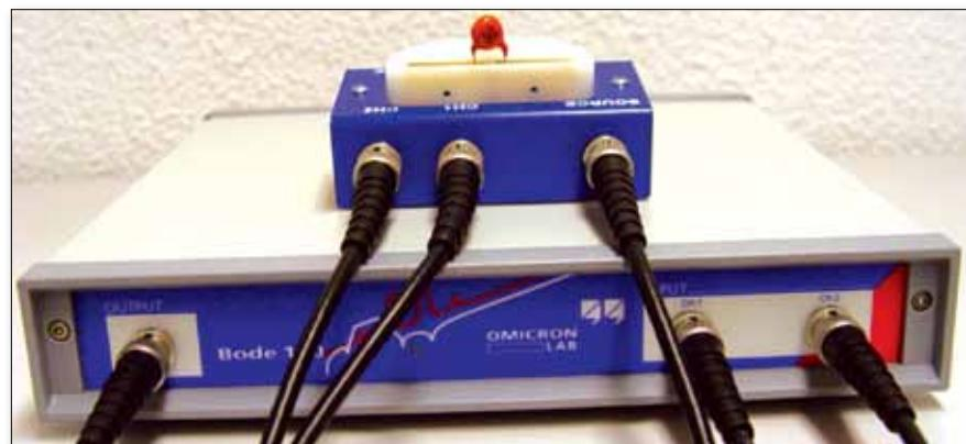
Bild 4: VNA mit Impedanz Adapter
