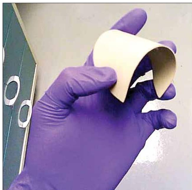
Versión flexible del adhesivo altamente conductor curado en un disco vde 1 mm de espesor.
