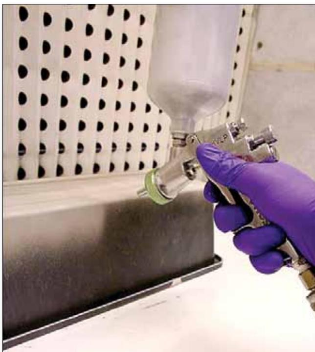
Aplicación por spray de capas de revestimiento epoxi altamente conductor sobre un sustrato de plástico.
