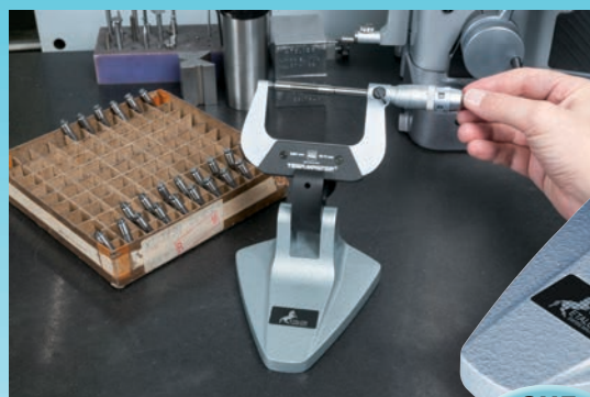
Messung einer kleinen Werkstückserie mit einem TESAMASTER und Ständer
