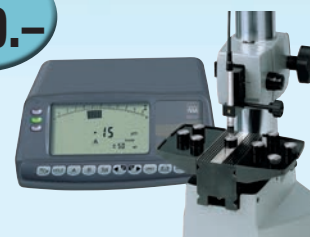
Anwendungsbeispiel mit induktiven Messtastern und TT 60
