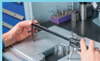
Bohrungsmessung nach der maschinellen Fertigung
