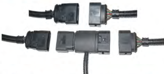
Fot.2 Przyłączenie adaptera do złącza pompy VP-37
