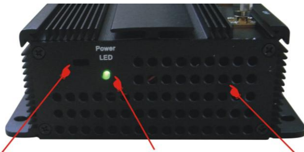
遥控模式开关(可选) Local本机设置 Remote支持遥控设置 (The optional switch of work node) 电源指示灯 (Pilot Lamp) 散热孔, 风扇内置 Cooling holes.
