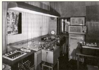
Tipičan studio za produkciju elektroničke glazbe 1950-ih - brojni magnetofoni, banke filtara, procesori zvuka synthesizera. Na slici prikazan studio njemačkog WDR-a
