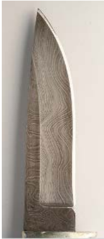
Figura G. Ilustração de uma lâmina de Damasco. A estrutura da lâmina é um aço forjado contendo de camadas alternadas de ferro duro e ferro maleável e obtido de um aço particular denominado "wootz" produzido na Índia.
