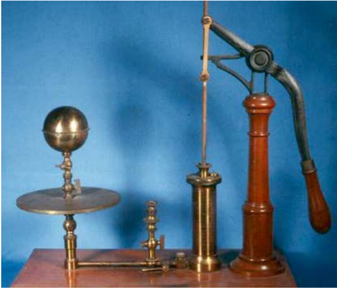
Figura EM. Ilustração de equipamento moderno para demonstração do experimento de von Guericke e bomba de sucção de ar.
