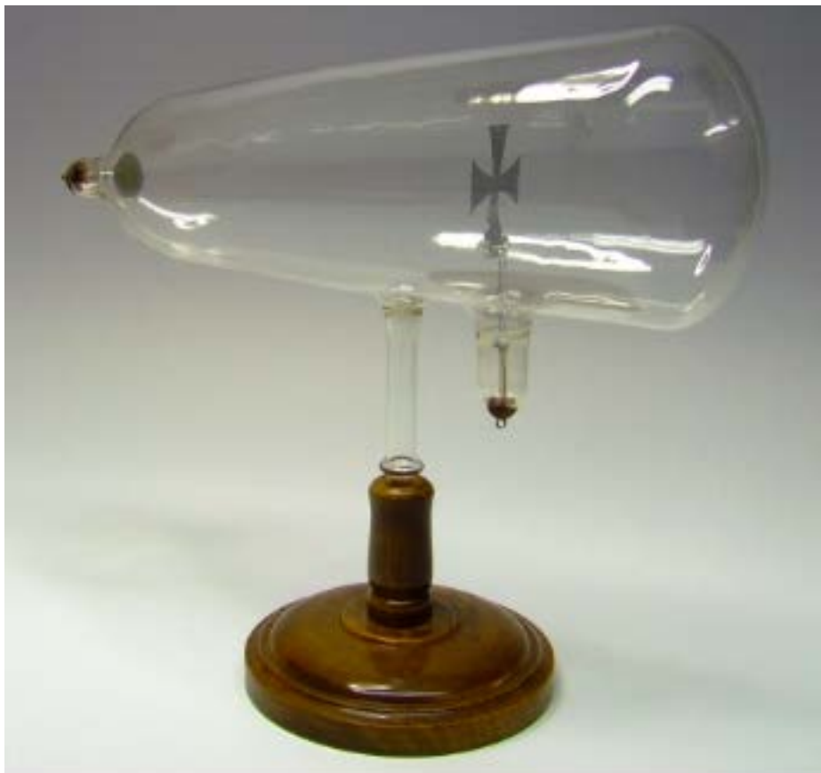
Figura NN. Modelo de tubo de Crookes do início do século XX.
