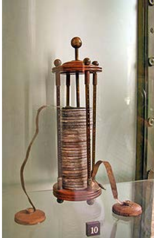
Figura NN. Uma pilha voltaica no seu aspecto original (Fonte: Tempio Voltiano, Como, IT)
