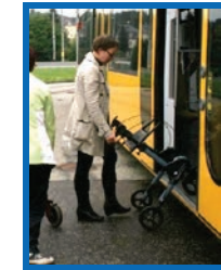
Korrektes Ankippen des Rollators zur Überwindung der Restschwelle
