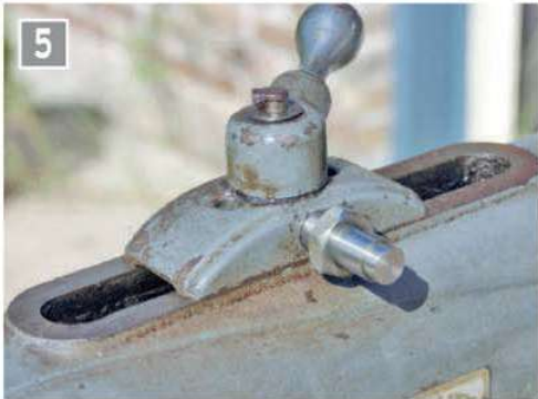
Ram rod hinge pin.
