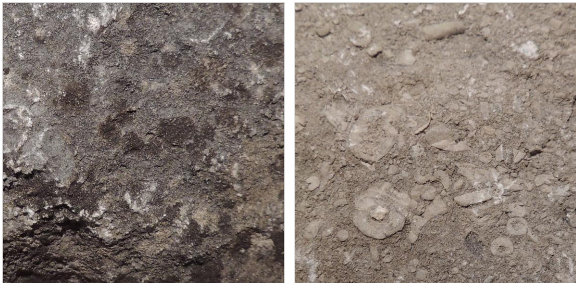
Figure 15 : Petit granite ; Articles de crinoïdes appartenant à la face cachée d'une pierre d'éboulis
