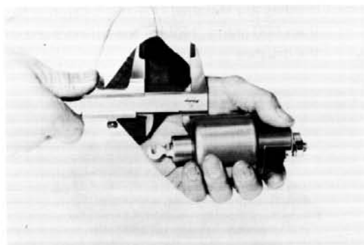
Fig. 6-18 Checking Moving Stud Length
