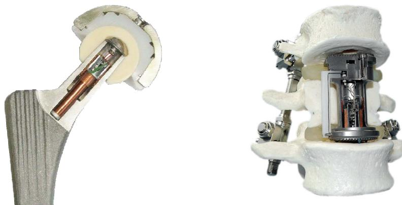
**Abbildung 1. Instrumentierte Hüftendoprothese (links) und Wirbelkörperersatz (rechts).**
