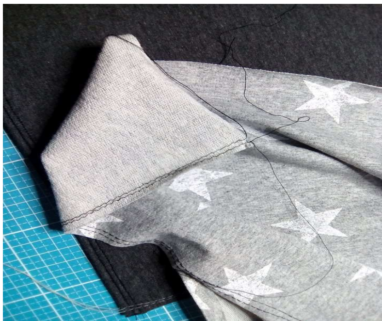
Nr. 6 Capetele firelor de ata se innoada (ata de sus cu cea de jos).
