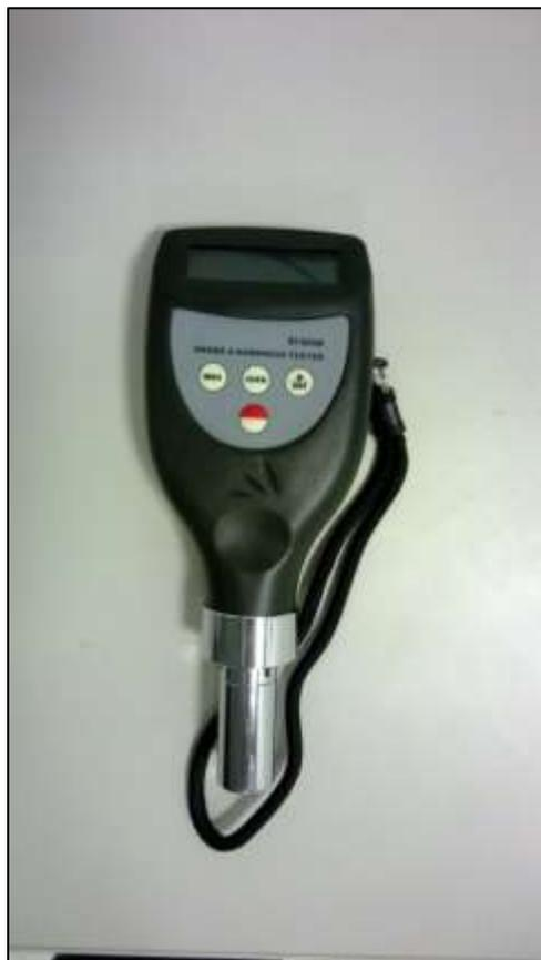
**Figura 4:** Durômetro Shore A da marca Reed modelo HT- 6510A - UFABC
