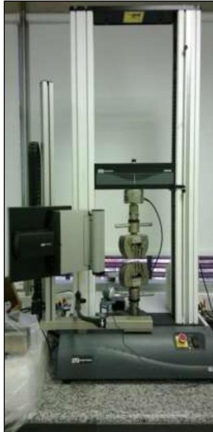
**Figura 5:** Máquina de ensaios universal Instron 4202 – UFABC
