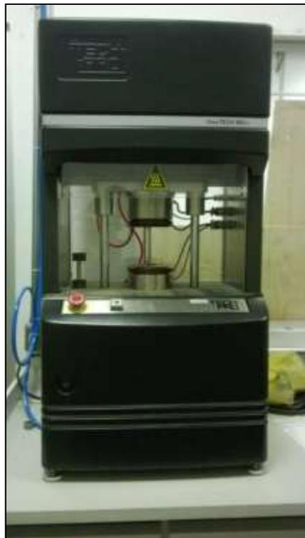
**Figura 3:** Reômetro de disco oscilatório tech Pro Rheo Yech MDPT - UFABC
