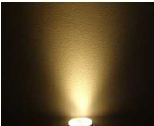
Slika 2.8.2. Izvor svjetla – ugao od 30°
