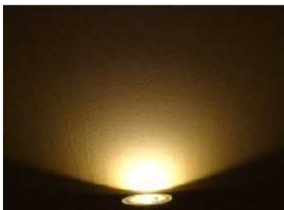
Slika 2.8.4. Izvor svjetla – ugao od 120°
