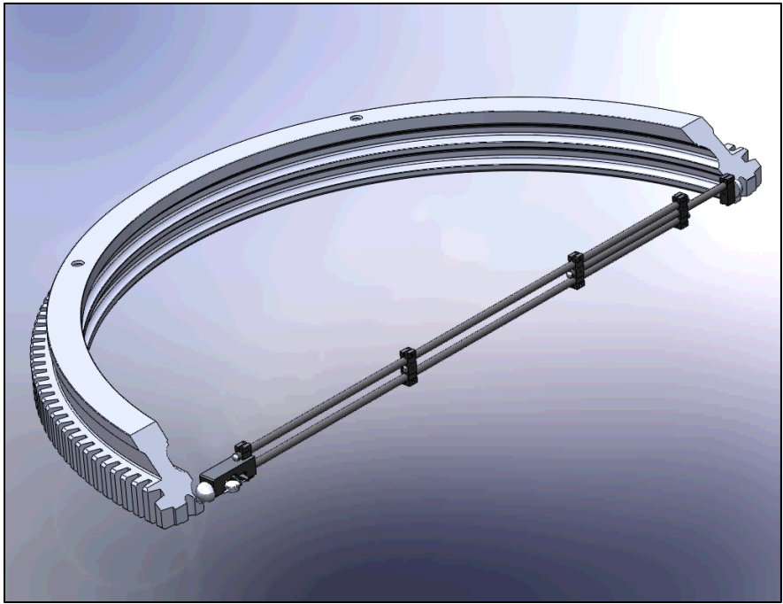
Bild 3: Messvorrichtung zum Bestimmen des Zweipunkt-Durchmessers großer Ringe
