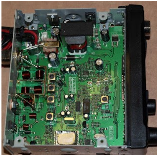
CB-radio OV-DELTA - PCB - spód radia (od strony głośnika).
