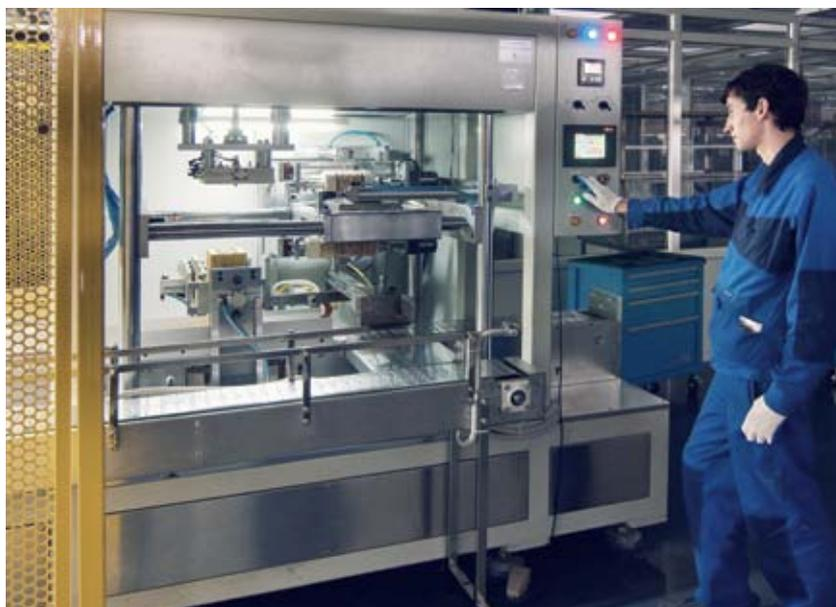
Аппарат запечатывания корпусов аккумуляторов на заводе «Лиотех»
